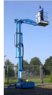
Bild: Hebebühne (das dargestellte Gitter bietet evtl. nicht ausreichend Schutz)
